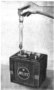
Fig. 14. Verificação da bateria
